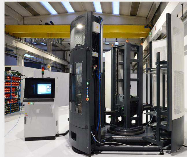
**Flexible Pallet Tower FTP** è composta da una navetta di trasporto munita di elevatore e da una serie di posizioni su magazzino a due piani.
